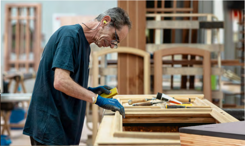
ATLANTEM, POSE DE MOULURES GRAND CADRE SUR UNE PORTE D'ENTRÉE © ATLANTEM
